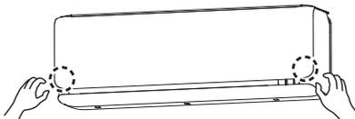
Удерживая нижние углы детали A, снимите крюк с основного корпуса.
